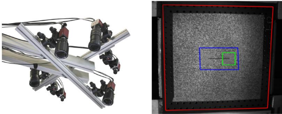
Figure 3 - Instrumentation de l'essai par Stéréo CIN : grappe de 6 caméras et 3 régions d'analyses correspondantes
