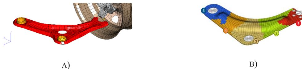
Figure 7 - a) Géométrie pièce initiale en Acier Haute résistance et b) géométrie conçue pour l'application composite avec zonage.
