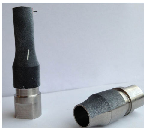
FIGURE 2 – Tube fin en torsion avec introduction d'un cycle de charge.
